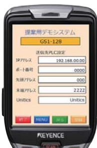
送信先PLC設定画面
