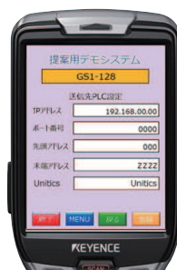
送信先PLC設定画面
